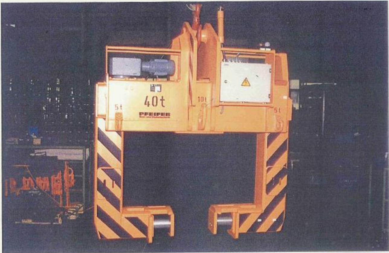
Oben: Teleskop-Coilzange 40 t. mit hydraulisch ausschiebbaren Pratzen. Nahoře: Teleskopické kleště s hydraulicky výsuvnými úchopnými patkami
