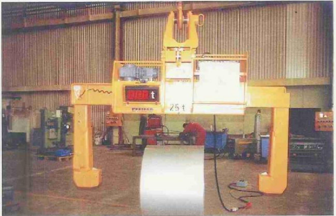
Teleskop-Coilzange 25 t. mit integrierter Wägeeinrichtung, Lastsicherung und Abschaltleisten
