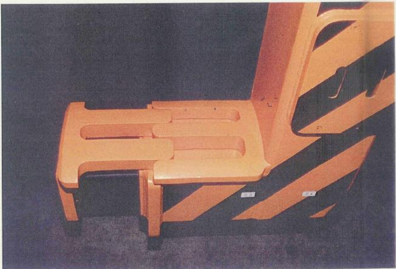
Unten: Detailaufnahme der Verschiebepatzen Dole: Detailní snímek výsuvných patek
